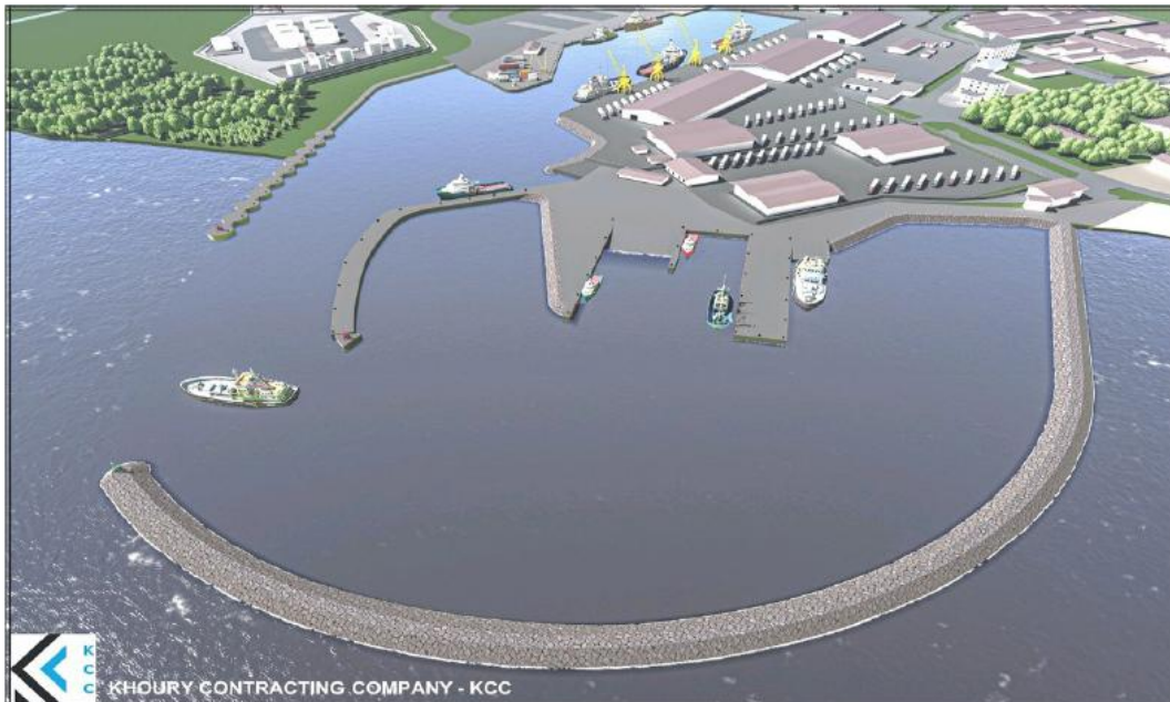
Figure 24 Conception du projet de réhabilitation du port de Bujumbura (section travaux maritimes)
