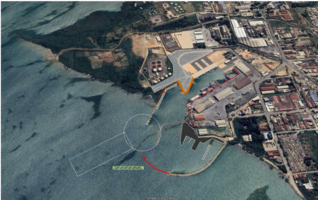
Figure 50 solution potentielle pour l'ajustement du canal d'accès
